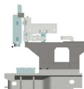
移動物を上方にコンパクトに配置し、加工点からガイドまでのストレスパスが小さい
